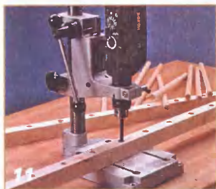
11 Глухие отверстия (по 14 шт.) в продольных брусках рам ограждения высверливают сверлом Форстнера.
