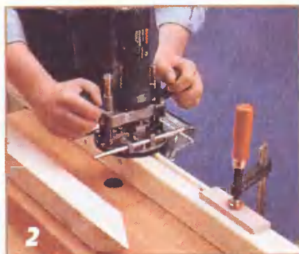
Пазы 10x15 мм предназначены для вклеивания в стойки панелей изголовья и изножья.
