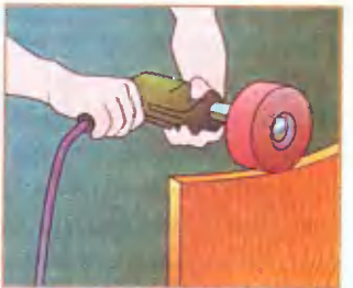
Рис. 29. Шлифовальный круг на основе пеноматериала позволяет равномерно, не задевая древесину, обрабатывать даже закруглённые поверхности.
