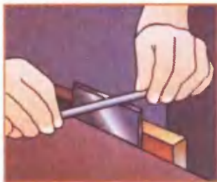
Рис. 11. Заточка цикли. Лезвие новой цикли сначала затачивают напильником, закрепив её в тисках.
