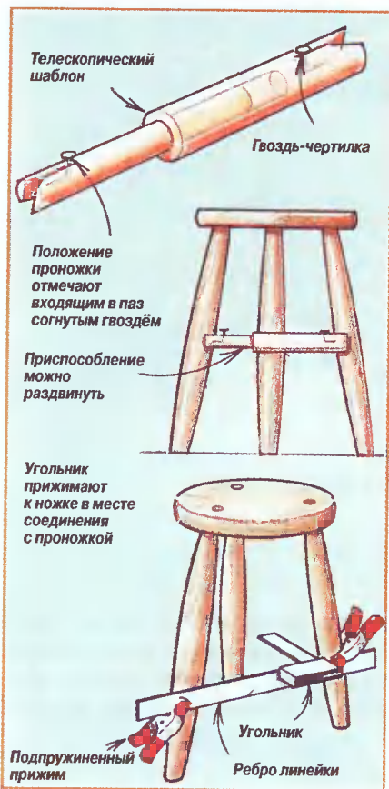
Рис. 1. Разметка отверстий для ножек.
