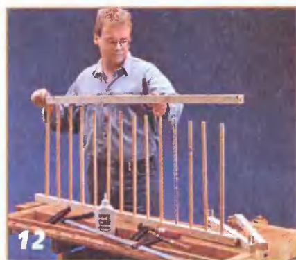
12 Собирая боковое ограждение, сначала вклеивают стержни в отверстия нижнего бруска рамы.
