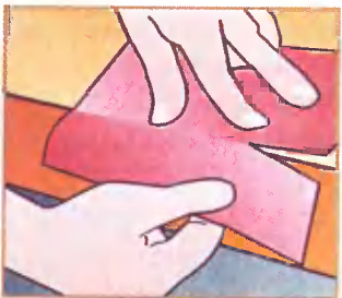
Рис. 25. Разделить на части шлифовальную шкурку можно о край верстака. Сначала её загибают, затем разрывают по линии сгиба. Резать шкурку не следует — затупится нож.
