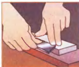
Рис. 12. Затем лезвие цикли доводят на оселке, меняя положение цикли из горизонтального в вертикальное.
