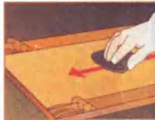
Рис. 15. Металлическую шкурку применяют для удаления покрытий с поверхностей, не подлежащих последующему покрытию морилкой или водорастворимой краской.
