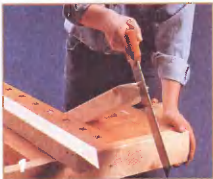
Остроконечные вершины стоек запиливают мелкозубой ножовкой по линиям разметки.
