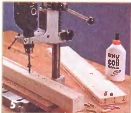
Отверстия под шканты следует делать сверлом с ограничителем глубины сверления.
