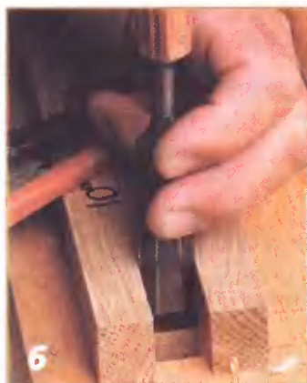
20-мм стамеской зачищают стенки начисто.
