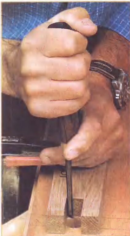
Поэтапный процесс обработки стамеской. С помощью направляющей 6-мм стамеской подрезают углы.
