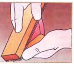
Рис. 26. Забитую частицами краски грубую шлифовальную шкурку прочищают металлической щёткой.
