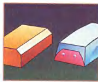
Рис. 21. С ровных поверхностей покрытия удаляют пробковым шлифовальным утюжком.
