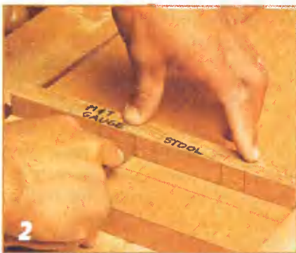
Разметка пазов на крышке с уже проведёнными двумя линиями, соответствующими толщине пазов. Остальные линии размечают по разметочной планке.
