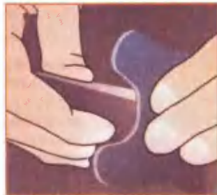
Рис. 13. Цикли бывают и изогнутой формы. С их помощью можно удалить покрытие с закруглённых поверхностей. А для заточки лезвий таких циклей применяют оселок соответствующей формы.
