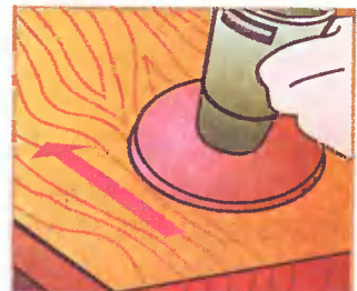
Рис. 27. Тарельчатая шлифовальная машинка годится только для грубой обработки поверхностей.
