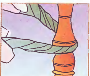
Рис. 23. Фигурные ножки, балясины и прочие детали с овальной формой зачищают узкой полоской шлифовальной шкурки или развернутой металлической шкуркой.
