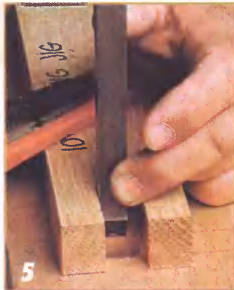
12-мм стамеской для пазов грубо обрабатывают остальные поверхности.
