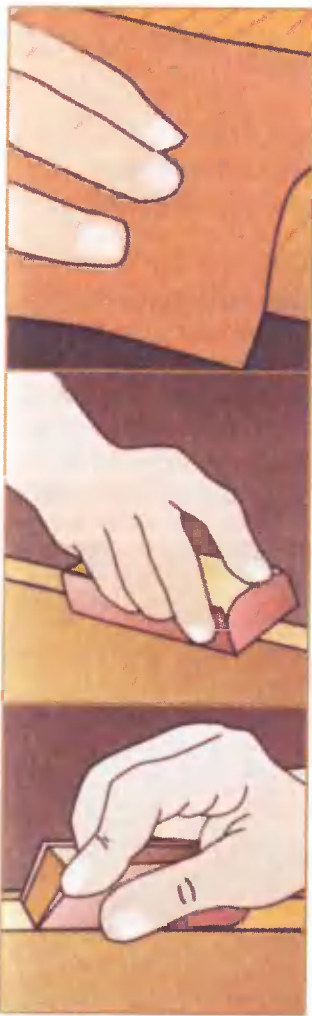
Рис. 18, 19 и 20. При обработке закруглённых поверхностей шкурку держат ладонью, прижимая к поверхности детали пальцами. Кромки и выпуклые поверхности обрабатывают отрезком деревянного бруска соответствующей формы, обёрнутого шлифовальной шкуркой.
